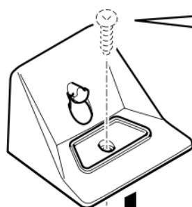
max.  $\varnothing 5.6\text{ mm}$
