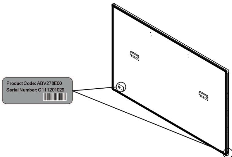
A etiqueta encontra-se na parte de trás do quadro, na parte inferior esquerda ActivBoard e extremidade lateral inferior.
