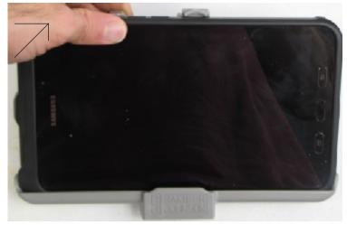
3. PRESS UP ON THE LATCH AND PULL THE TABLET OUT
