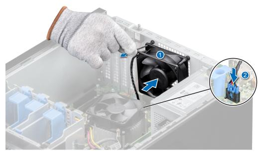
Figure 27. Installing a cooling fan
