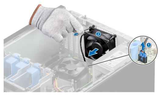
Figure 26. Removing the cooling fan
