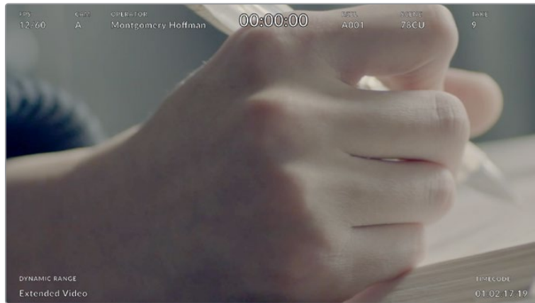
Blackmagic Studio Camera 4K ProはSDI出力に監督用のステータステキストを表示可能
