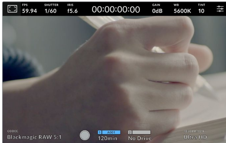
Blackmagic Studio Camera에 히스토그램과 오디오 미터가 표시되던 곳에 코덱과 해상도 정보를 표시할 수 있습니다.
