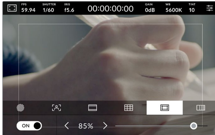
Der Schutzbereich-Indikator ist auf 85 % eingestellt
