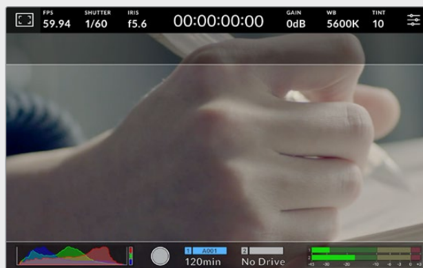
LCD-Touchscreen mit aktivierten 2,40:1-Bildrandmarkierungen
