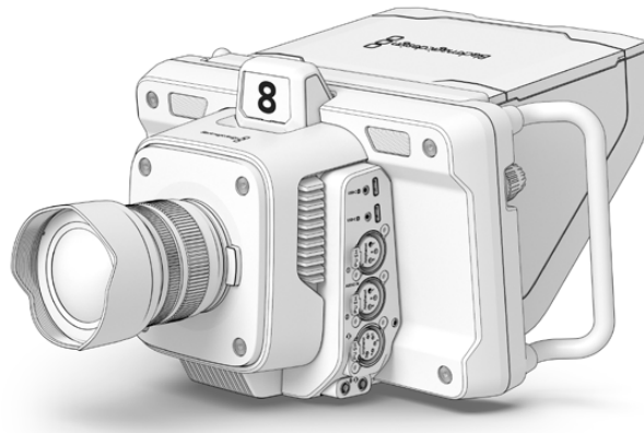
Die Gegenlichtblende schützt den Bildschirm und beschattet ihn in hellen Umgebungen
